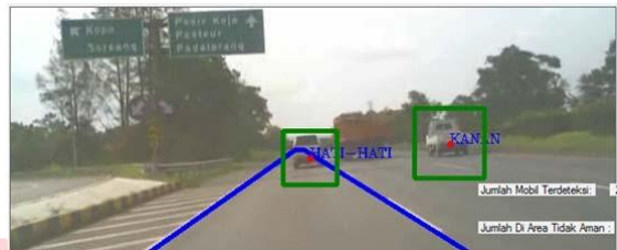
Gambar 3.4 Deteksi gerakan mobil berdasarkan perpindahan piksel
