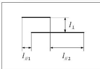
Gambar 1. Contoh untuk Menghitung Paralel dan Jarak Tegak Lurus
