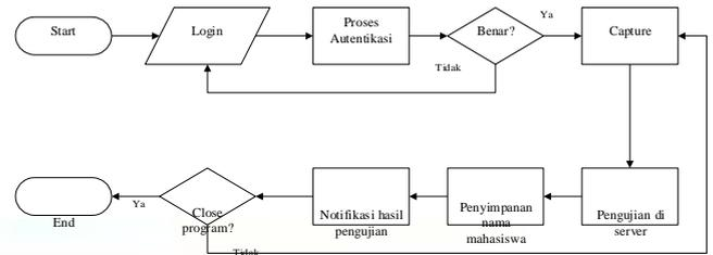
Gambar 2. Diagram Alir Sistem Keseluruhan
