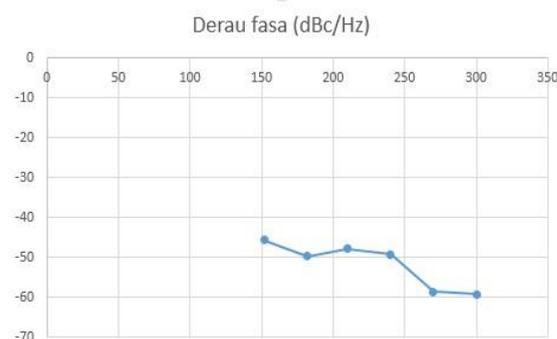
Gambar 16. Hasi pengukuran *phase noise*
