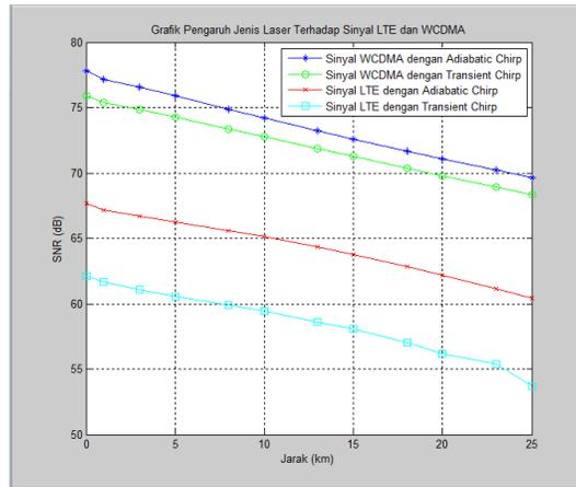
Gambar 8. Grafik Hasil Pengujian Pada Skenario Simulasi Kedua
