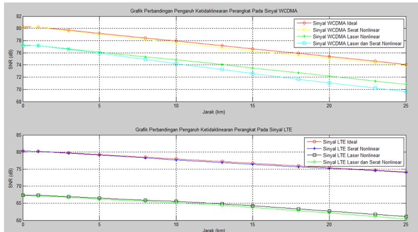
Gambar 7. Grafik Hasil Pengujian Pada Skenario Simulasi Pertama
