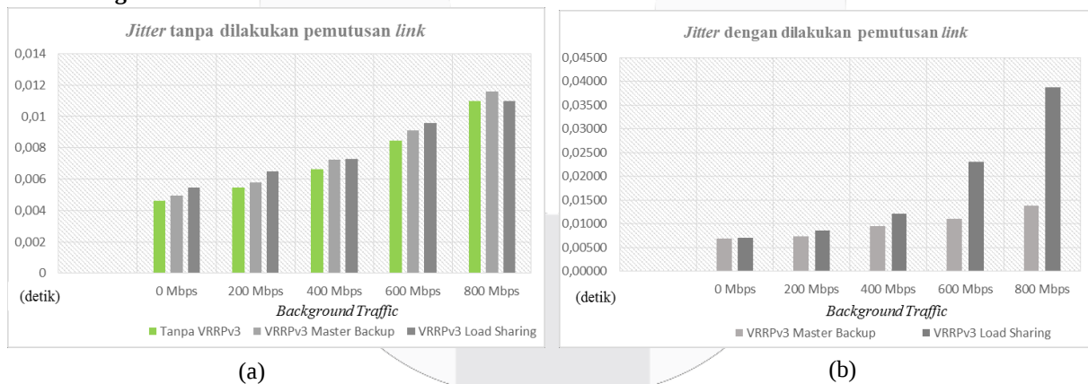
Gambar 7 (a) Pengukuran Jitter tanpa dilakukan pemutusan link dan (b) dengan dilakukan pemutusan link
