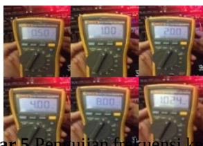
Gambar 5 Pengujian frekuensi keluaran square signal generator
