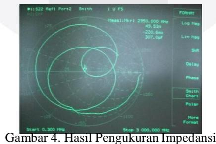
Gambar 4. Hasil Pengukuran Impedansi
