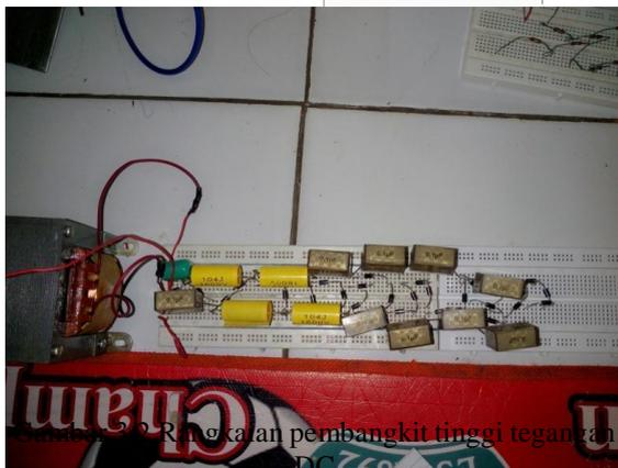
Gambar 3.2 Rangkaian pembangkit tinggi tegangan DC
