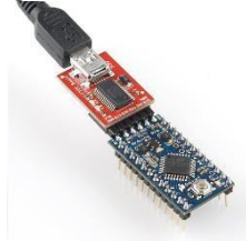
Gambar 15 Pemasangan USB to Serial pada Arduino Pro Mini
