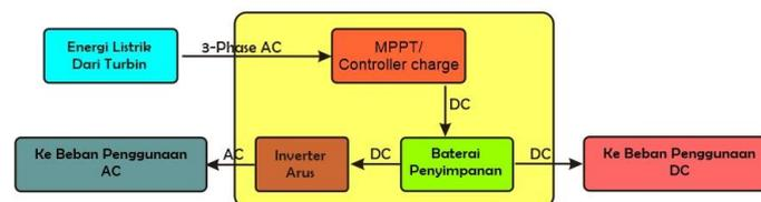
Energi listrik berasal dari turbin yang digerakkan oleh kincir angin, arus listrik masih berupa arus bolak balik ( Alternating Current ) kemudian listrik masuk menuju MPPT ( Controller ) yang mengubah arus AC menjadi DC dan kemudian disesuaikan dengan kapasitas baterai penyimpanan, sehingga tidak terlalu berbahaya untuk disimpan di baterai. Energi listrik dari baterai bisa langsung digunakan oleh beban DC maupun AC melalui inverter terlebih dahulu
