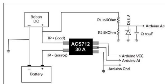
Gambar 3.2 Skematik Voltage Divider dan Sensor Arus
