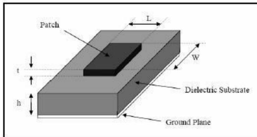
**Gambar 2** Struktur dasar antenna mikrostrip<sup>[1]</sup>
