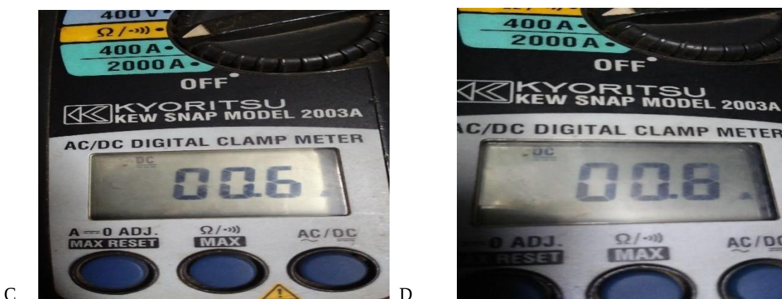
Gambar 4.2.1 Pengukuran arus (C) pada tegangan 3.3V (D) pada tegangan -12V
