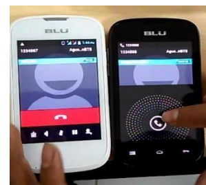
Gambar 4.2 Pengujian komunikasi suara dari nomor 1234568 ke 1234567
