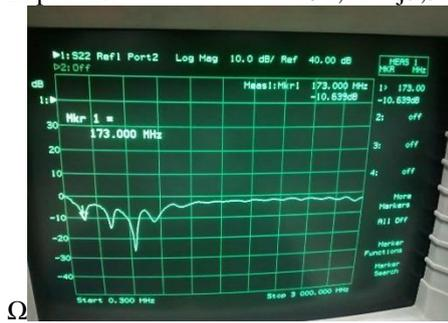
GAMBAR 4 4 (HASIL PENGUKURAN RETURN LOSS ANTENA TX)
