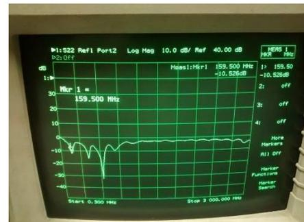
GAMBAR 4 3 (HASIL PENGUKURAN RETURN LOSS ANTENA RX)
