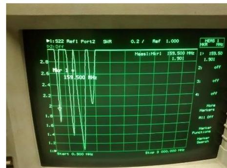
GAMBAR 4 2 (HASIL PENGUKURAN VSWR ANTENA RX)
