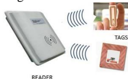
Gambar 2 Ilustrasi Komunikasi RFID [4]
