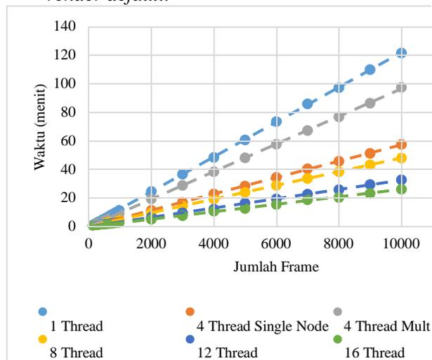
Gambar 4-1 : Grafik waktu *render cluster* untuk 1 objek *dolphin* berdasarkan perubahan jumlah *frame* dan jumlah *thread*
