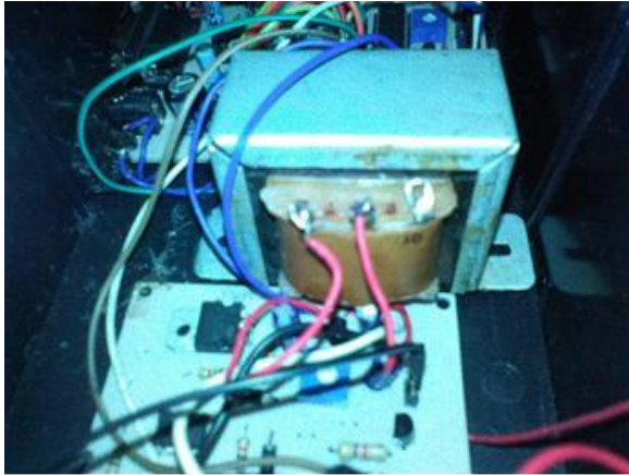
Gambar 11 Bentuk Fisik Rangkaian Oscilator Armstrong
