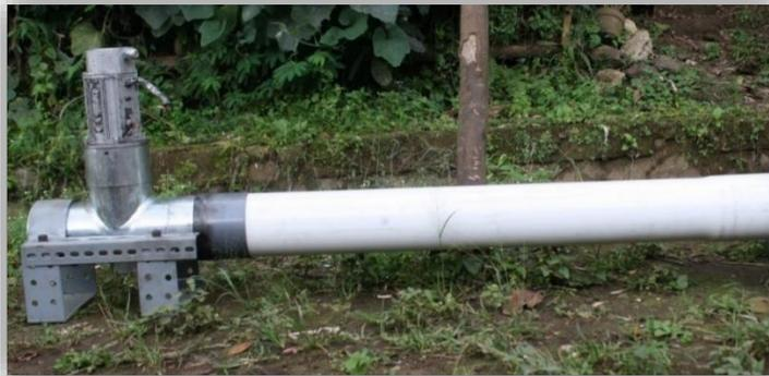
Gambar 3.19. Sistem Pembangkit Listrik Skala Piko hidro dengan menggunakan *Turbin Bulb*.
