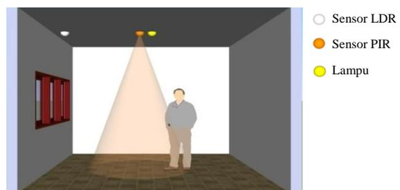
Gambar 2: Ilustrasi penerapan LCS pada ruangan
