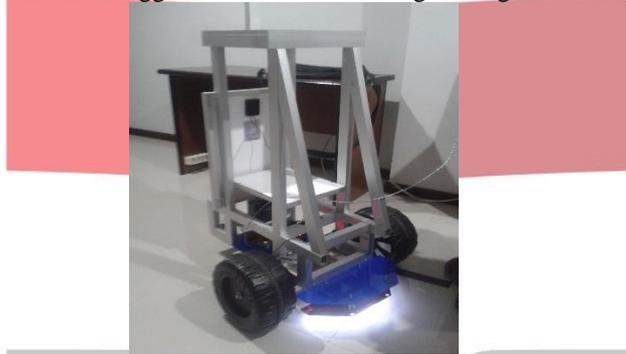
Gambar 3. Rangka Robot yang Digunakan.
