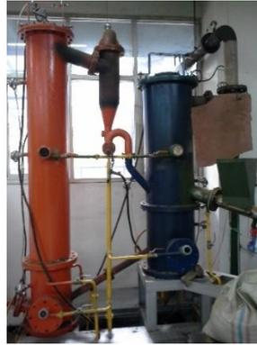
Gambar 1. Reaktor Gasifikasi *Circulating Fluidized Bed*
