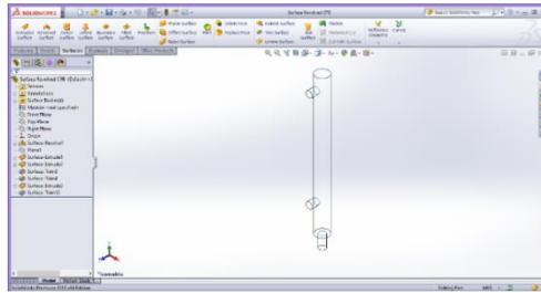
Gambar 3. Model Reaktor Gasifikasi CFB pada Solidwork 2013
