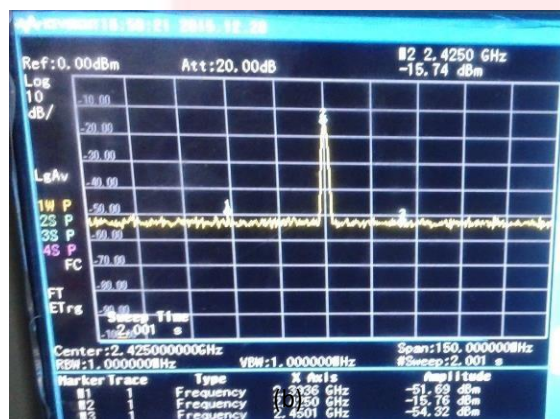
Gambar 3.9 Tipe level daya dan noise frekuensi 2.425 GHz (a) Input LNA (b) Output LNA
