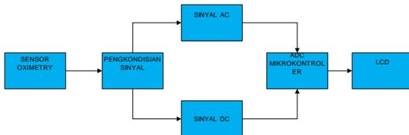
Gambar 3.1 Diagram Blok Sistem
