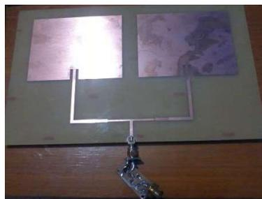
Gambar 6 Rectenna (Rectifier Antenna)
