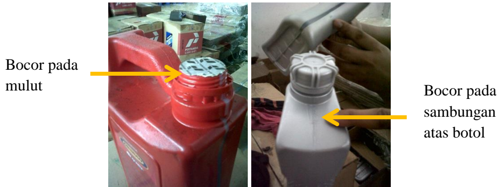
Gambar I. 4 Cairan pelumas keluar pada bagian atas botol
