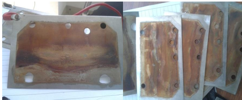
Gambar 1.2 Plat Stainless Steel yang Digunakan sebagai Katoda dan Anoda pada Dry Cell .
