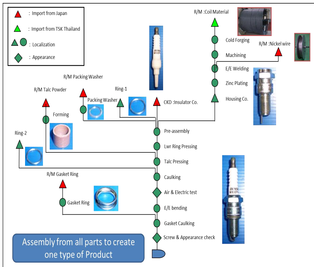
Gambar I.2 Alur Produksi Spark Plug di PT DNS
