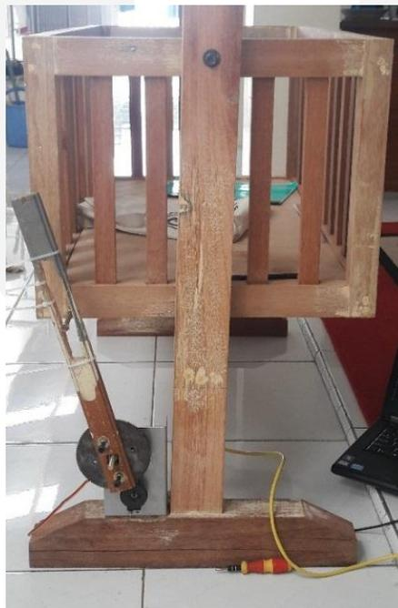
Gambar 3 Pemasangan Penggerak Pada Keranjang Bayi
