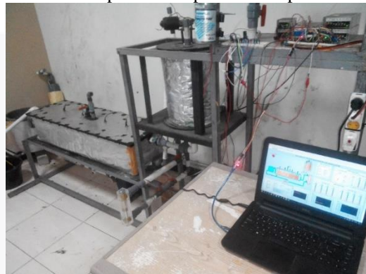
Gambar 4. 1. Proses pengujian sistem pemantauan dan pengendalian reaktor ABR
