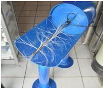
Gambar I.1 Kondisi Alat pencuci galon eksisting
