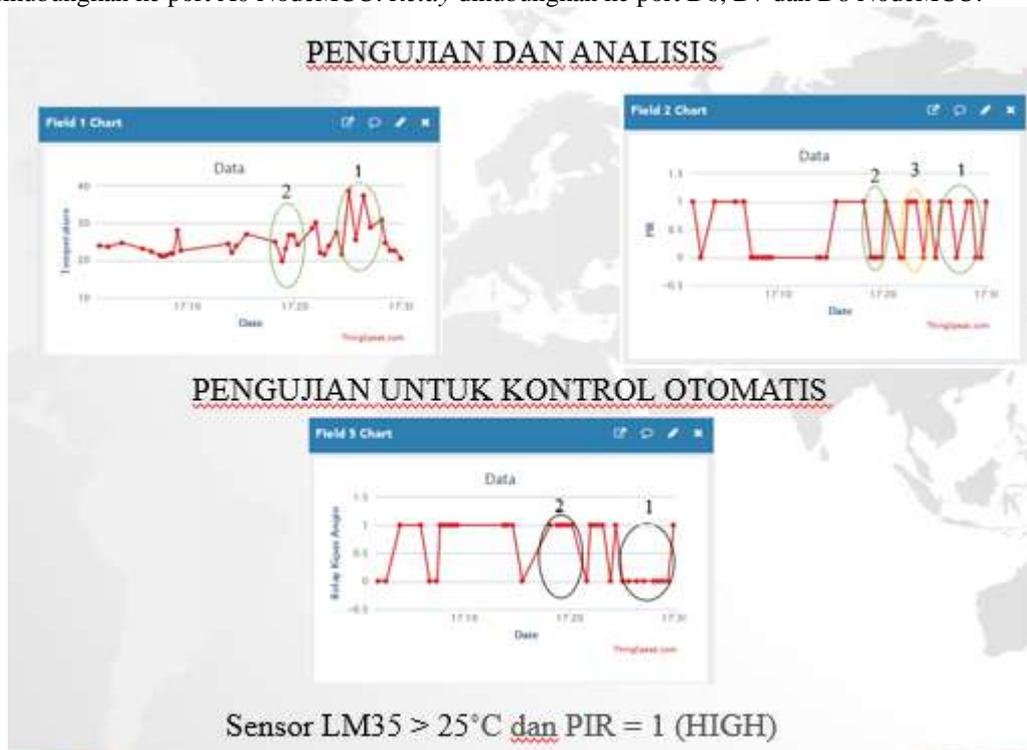
**Gambar 4. 1 Kontrol Otomatis pada beban Kipas Angin**
