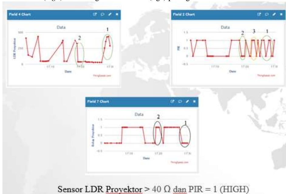
**Gambar 4. 3 Kontrol Otomatis pada beban Proyektor**
