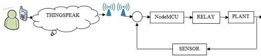
Gambar 3.2 Diagram Blok
