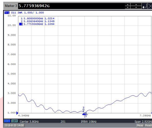
Gambar 4.3 Pengukuran VSWR Kondisi On Body
