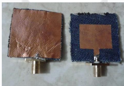
Gambar 4.1 Hasil Pabrikasi Antena Tampak Belakang dan Depan
