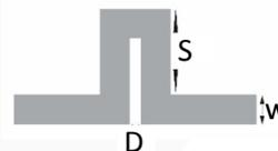
Gambar 2.3 Kopling antara Resonator dan Saluran I/O
