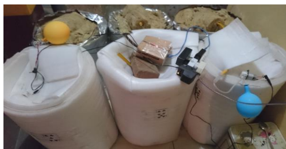
Gambar 3.2 Proses produksi volume biogas pada wet dan dry digester menggunakan bahan insulasi rockwool dan polyfoam
