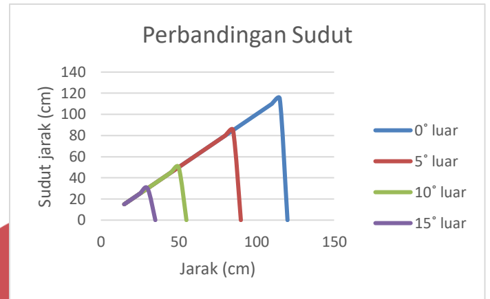
Gambar 4. 4 Sudut Penerimaan Photodioda Bagian Luar Garasi
