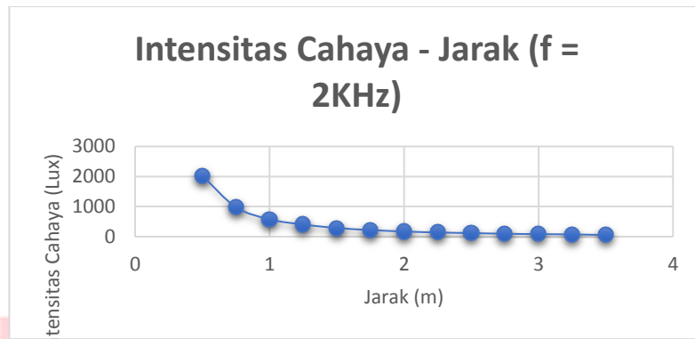
Gambar 4.2 C Pengaruh jarak terhadap intensitas cahaya pada frekuensi 2 KHz
