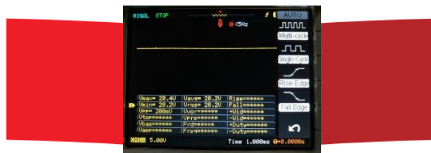
Gambar-11 Tegangan DC hasil keluaran filter kapasitor
