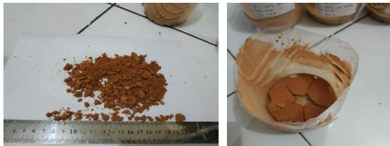
Gambar 6. 5 Perbandingan sebelum dan setelah digiling dengan durasi penggilingan 1 jam dan duty cycle 50%
