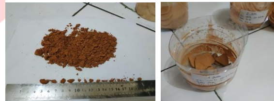
Gambar 6. 6 Perbandingan sebelum dan setelah digiling dengan durasi penggilingan 1 jam dan duty cycle 100%
