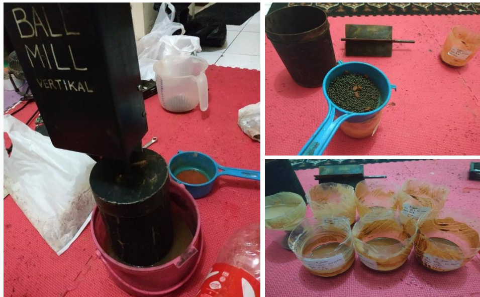
Gambar 5. 3 Penggilingan Dengan Bahan Serpihan Batu Bata, Penyaringan Bahan, dan Hasil Penggilingan
