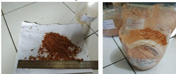
Gambar 6. 7 Perbandingan sebelum dan setelah digiling dengan durasi penggilingan 2 jam dan duty cycle 50%
