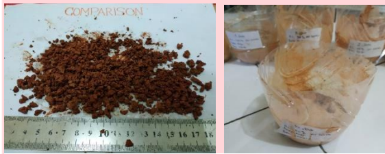
Gambar 6. 3 Perbandingan sebelum dan setelah digiling dengan durasi penggilingan 30 menit dan duty cycle 50%
