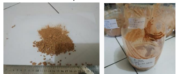
Gambar 6. 8 Perbandingan sebelum dan setelah digiling dengan durasi penggilingan 2 jam dan duty cycle 100%
