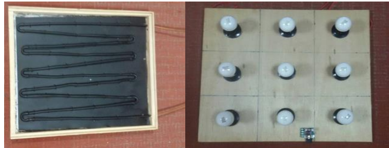
Gambar 1 Kolektor Termal Surya dan Simulator Radiasi Matahari
