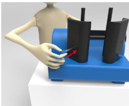
Gambar 13. Memasang pisau cutter (Sumber : Dokumentasi Penulis, 2019)
