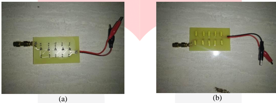
Gambar 10. Realisasi Rectifier : (a) Tampak Depan (b) Tampak Belakang
