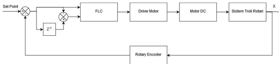
Gambar 9. Diagram Blok Kontrol Posisi
