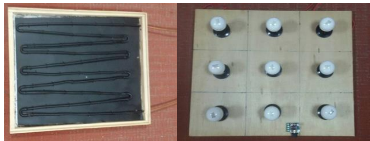
Gambar 1 Kolektor Termal Surya dan Simulator Radiasi Matahari
