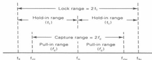
**Gambar 2.** Gambar Daerah Lock Range dan Capture range [4].
