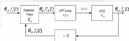
Gambar 1. Blok diagram PLL [3].
