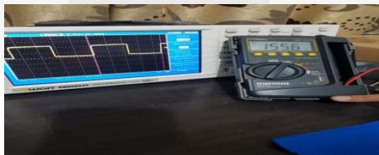
Gambar 8. Sinyal Kotak dengan Frekuensi 40Khz.
