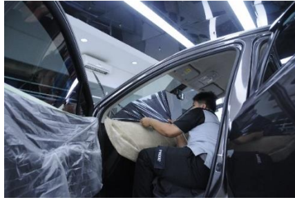
Gambar. 11 Pemasangan Kaca Film
