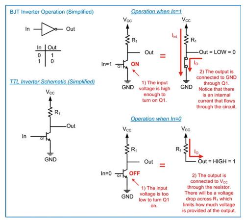
Fig. 3.31 TTL inverter
