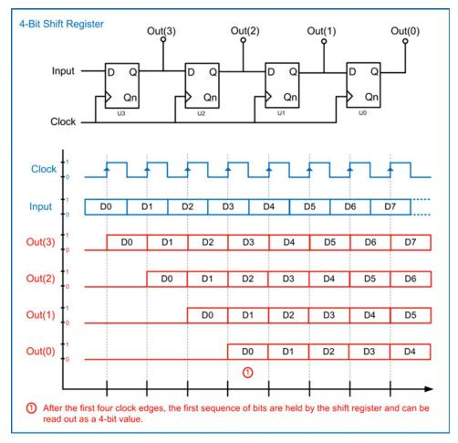
Fig. 7.28 4-Bit shift register
