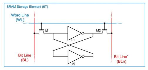
Fig. 10.10 SRAM storage element (6T)
