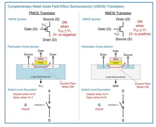
Fig. 3.21 CMOS transistors
