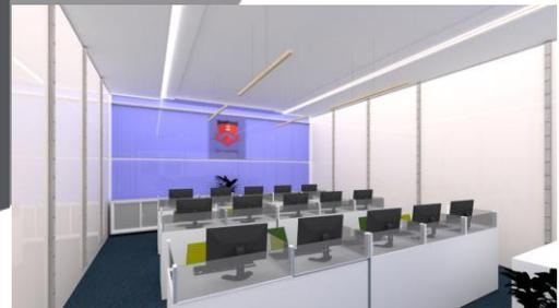
*Treatment* ceiling menggunakan lampu dengan sistem pencahayaan *spotlight* dan *downceilling* yang menggunakan lampu TL dengan sistem pencahayaan *diffuse*.
