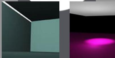
Penerapan Accent lamp pada area koridor. Menggunakan konsep light steam, Jenis general lamp, dan teknik Semi-direct dengan penggunaan lampu LED Strip yang dipasang pada pinggir langit-langit ruang. Penerapan General lamp pada area kelas. Menggunakan konsep hotspot – mengarah pada titik tertentu, dan teknik Diffuse, dengan lampu TL.
