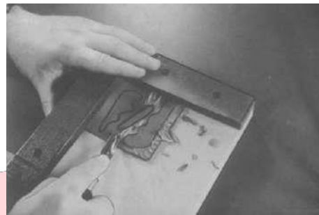
Gambar 1. Pembuatan Plat Cetak Block Printing menggunakan Linoleum Sumber: The Hand Decoration of Fabric , J.Kafka 1959
