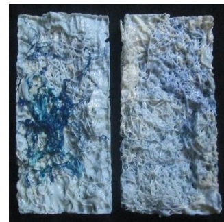
Gambar 4. Lembaran keras dari olahan limbah badan botol plastik
