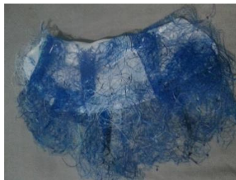
Gambar 7. Limbah botol plastik yang telah dijahit mesin
