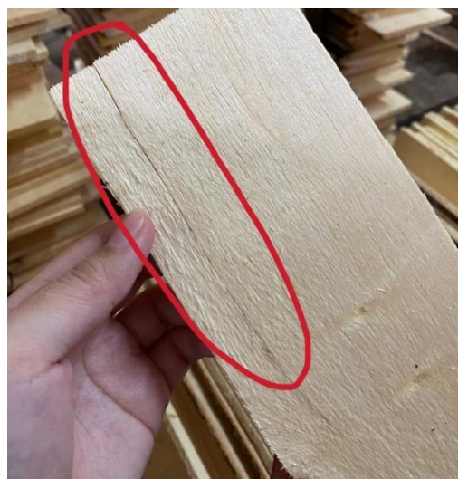
Gambar 2 Visualisasi Cacat Retak pada Slat 7A1
